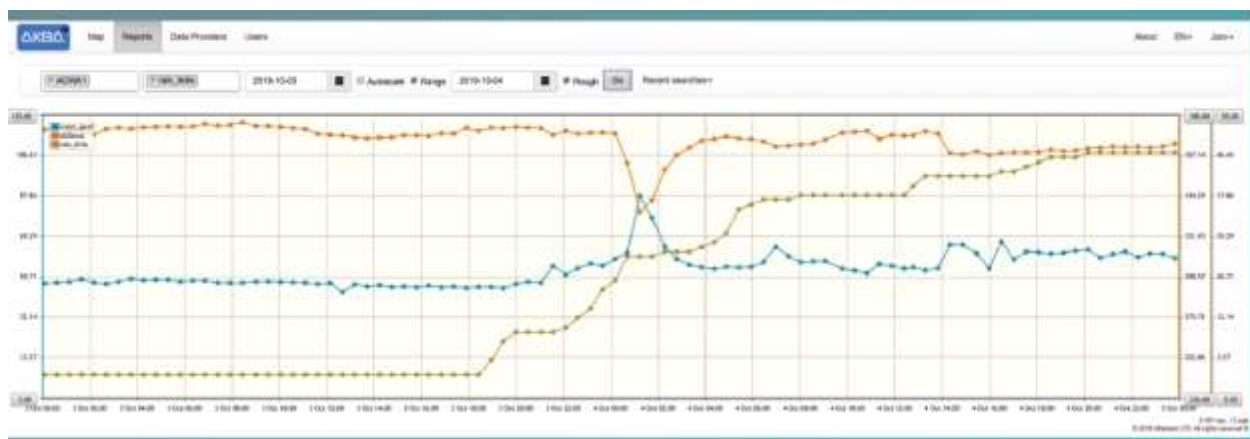
Фиг. 4 Типични криви на изменението на нивото на река, измерено то дъното до повърхността и от датчик до повърхността на реката. Източник ДАПП.
